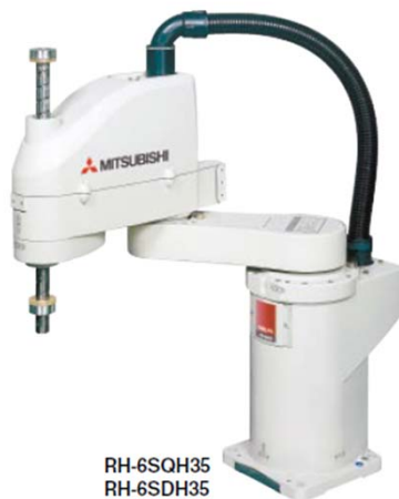
▲水平多関節型ロボット 出所: 三菱電機Webページ
