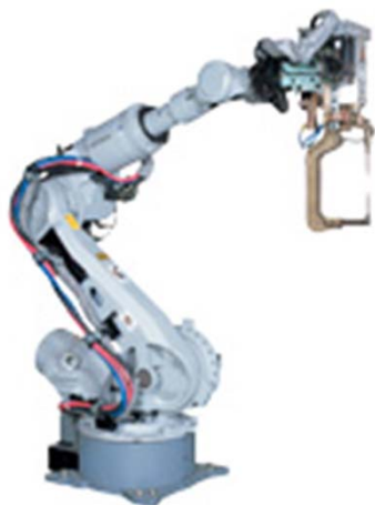
▲垂直多関節型 溶接ロボット 出所: 安川電機Webページ
