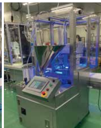
刻みネギ盛付ロボットシステム
