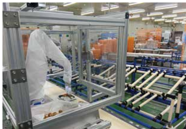
触覚ハンド活用多品種対応フライ投入兼盛付ロボットシステム
