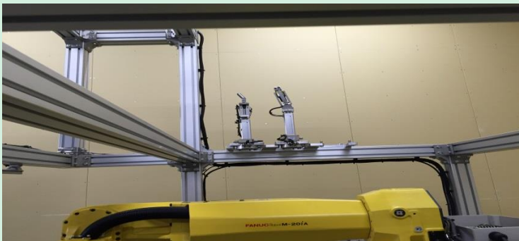
①マグネット吸着ハンド ②エアージャックハンド ③エア吸着ハンド (本体装着中)
