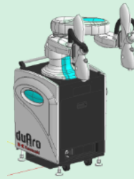
duAro:協働作業ロボット 安全柵が不要の 双腕スカルロボット
