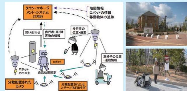
図6 ロボットタウンでの環境情報構造化
